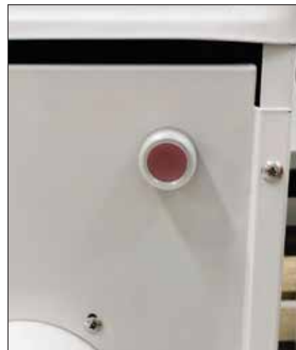
Tryck och håll nere reversknappen om brännarluckan inte stängs riktigt.
