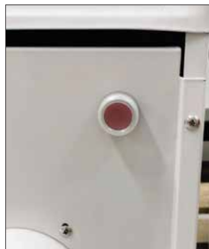
Hold inne reversknappen hvis brennerlukene ikke lukker seg på riktig måte.
